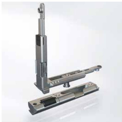
Скрытая оконная фурнитура Точки запирания с защитой от выламывания способствуют повышению уровня защиты от взлома
