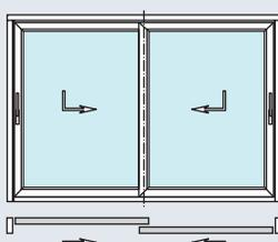
В двухстворчатом исполнении возможен вариант с одной рабочей створкой, либо с двумя подвижными.
